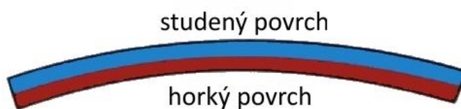
Obr. 4 Vliv teplotního rozložení, vznik ohybu [6]
