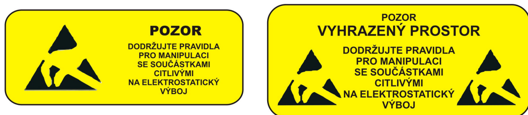
Obr. 63. Příklady štítků upozorňujících na nebezpečí ESD.
