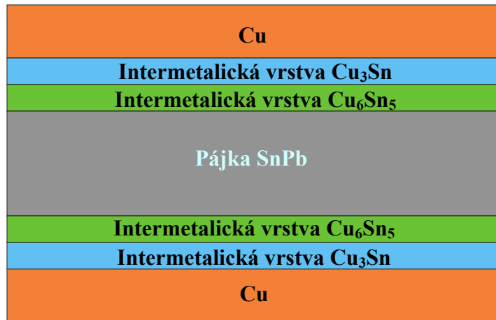
Obr. 67. Pájený spoj s intermetalickými slitinami.
