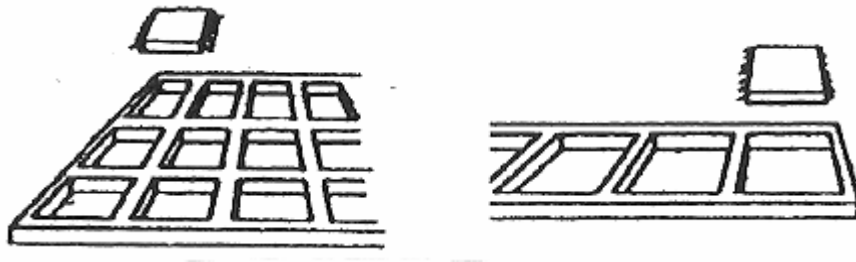
Obr. 5. Paletové zásobníky pro balení SMD.
