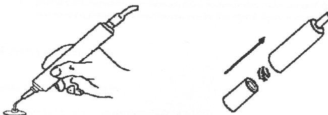
Obr. 80. Práce s vakuovou pinzetou.
