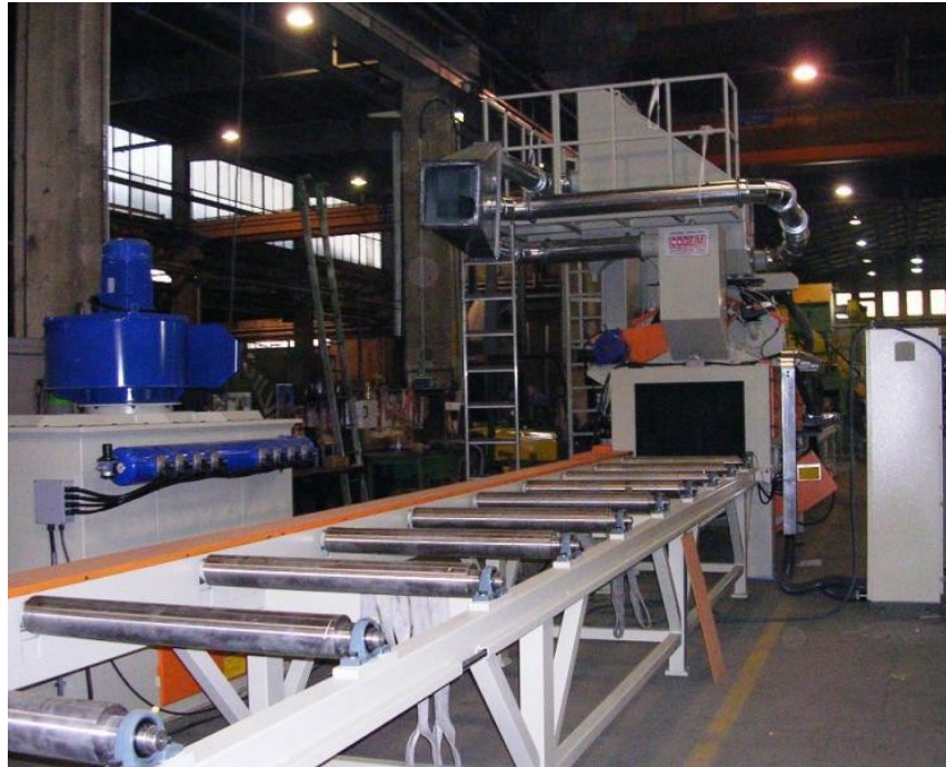
Obrázek 11 Tryskací stroj s metacími koly [24]
