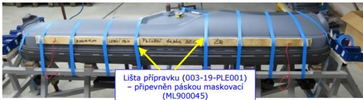
Obrázek 15 Upevnění vnějšího dílu
