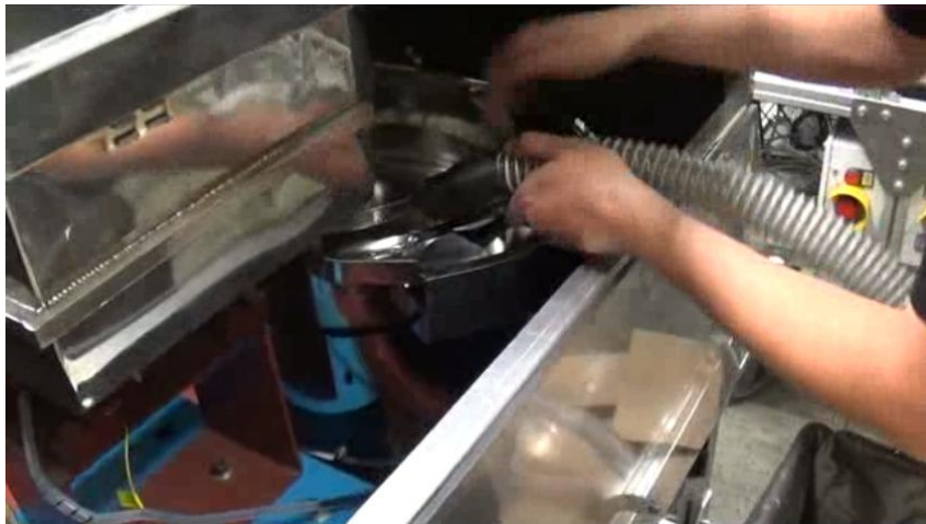
Obrázok 26 – Odstraňovanie viečok z bubnu vysávaním (vlastné spracovanie)
