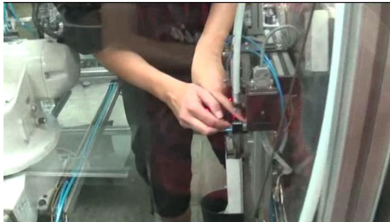
Obrázok 23 – Odstraňovanie viečok z lineáru dávkovača viečok (vlastné spracovanie)
