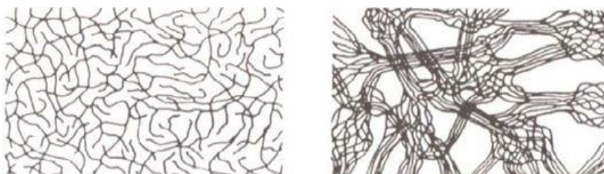
Obr. 3 Schéma struktur: amorfní termoplast (vlevo), semikrystalický termoplast (vpravo). [2]
