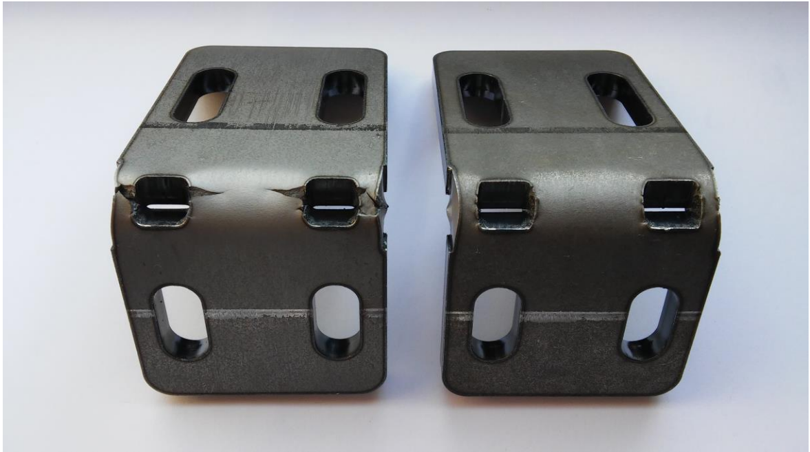
Obr. 32. Výrobky obou materiálů při orientaci vláken kolmo k ose ohybu; zleva: materiál s obsahem uhlíku 0,17% a materiál s obsahem uhlíku 0,12%. [Zdroj: vlastní]
