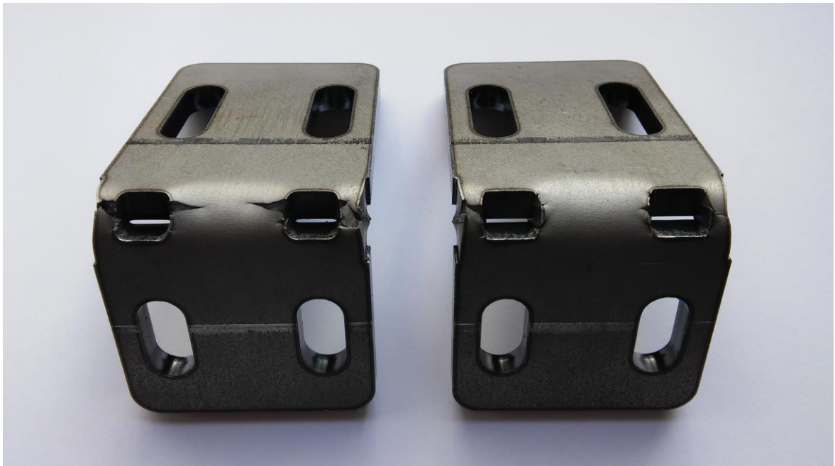
Obr. 33. Oválný výřez (vlevo), obdélníkový výřez (vpravo). [Zdroj: vlastní]
