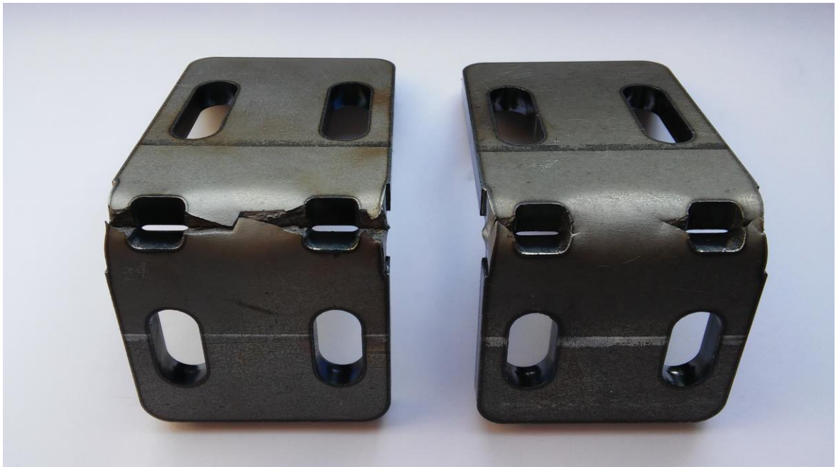
Obr. 31. Praskliny obou materiálů při rovnoběžné orientaci vláken s osou ohybu; zleva: materiál s obsahem uhlíku 0,17% a materiál s obsahem uhlíku 0,12%. [Zdroj: vlastní]
