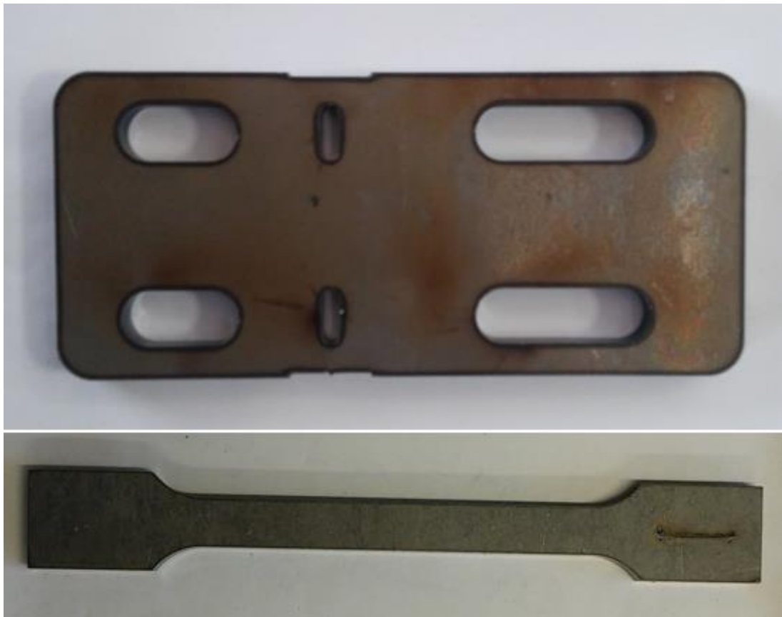
Obr. 26. Připravené tvary vzorků pro experiment. [Zdroj: vlastní]
