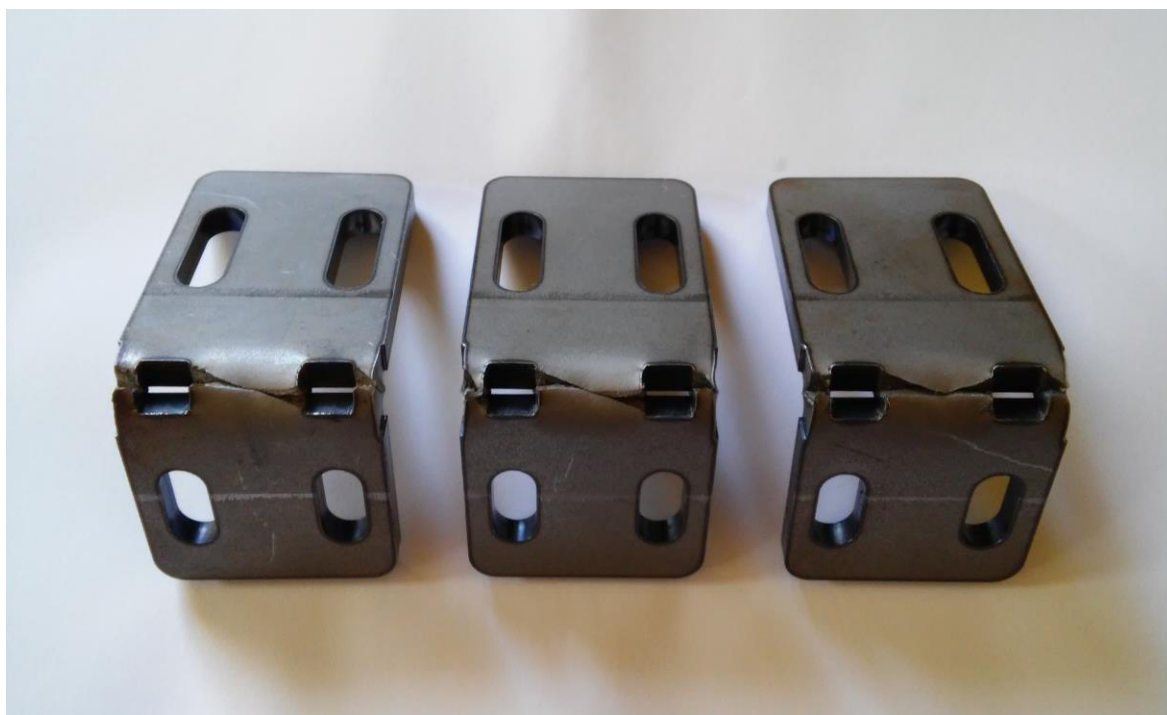
Obr. 35. Vliv použití maziv (zleva: ohýbáno bez maziva, Total Martol EV 45, Total Martol Soluble 130). [Zdroj: vlastní]
