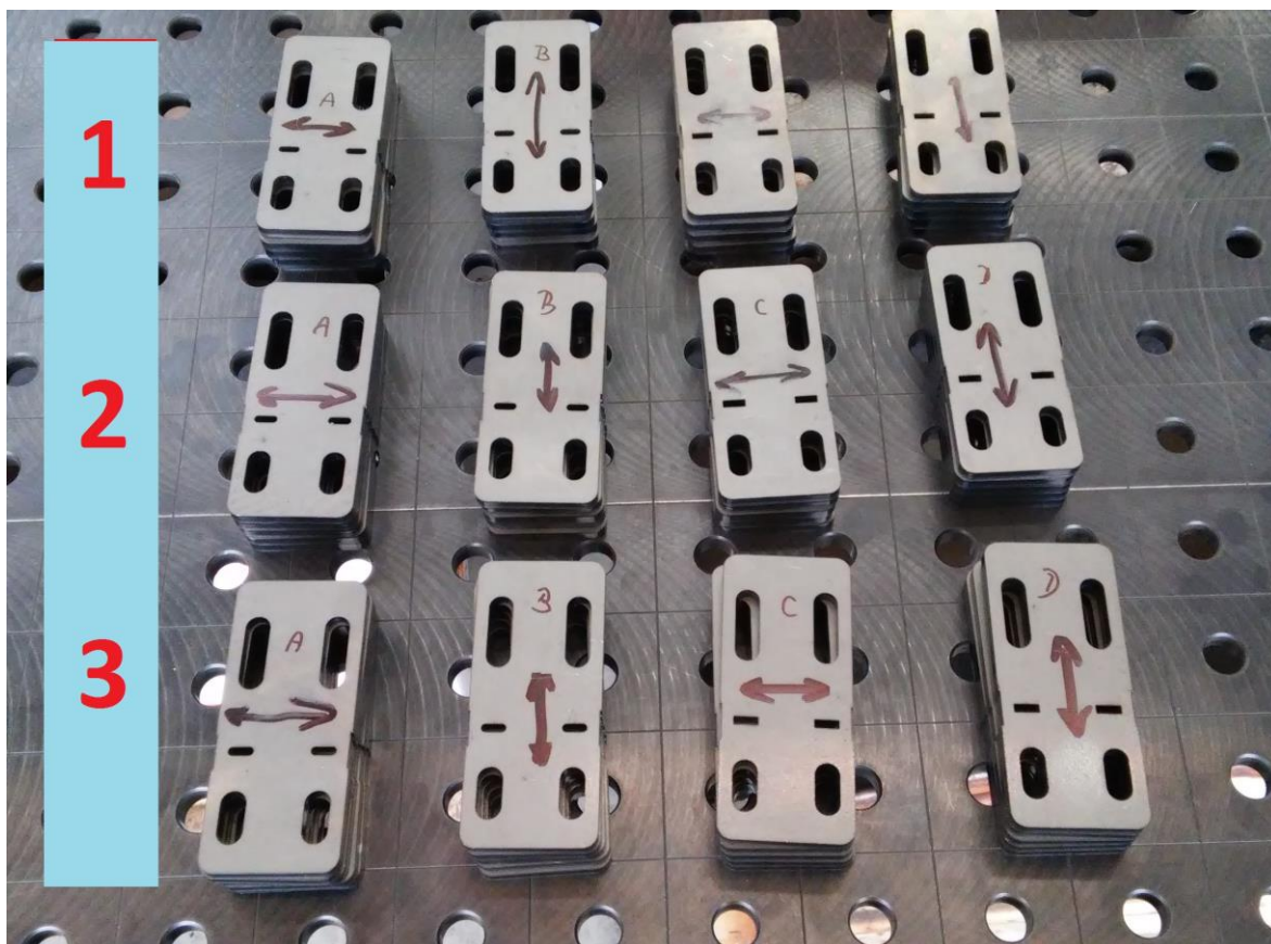
Obr. 34. Skupiny vzorků dle druhu maziva, typu výřezu a orientace vláken struktury.
