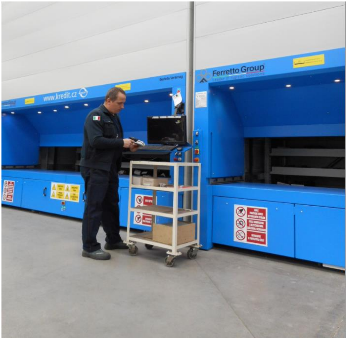
Obr. 33 Operátor meziskladu naskladňuje dílce pomocí čárového kódu (vlastní zpracování dle interních materiálů)
