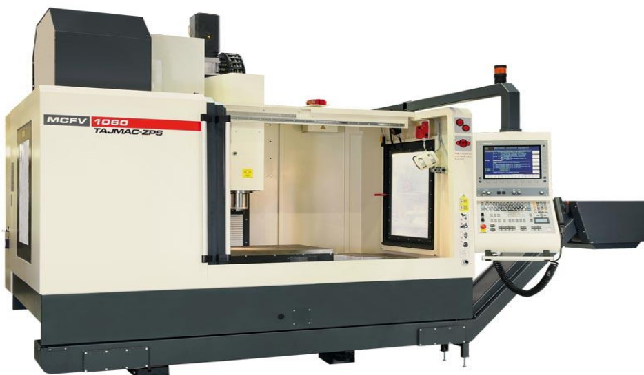
Obr. 12 Vertikální obráběcí centrum MCFV 1060 (vlastní zpracování dle interních materiálů)
