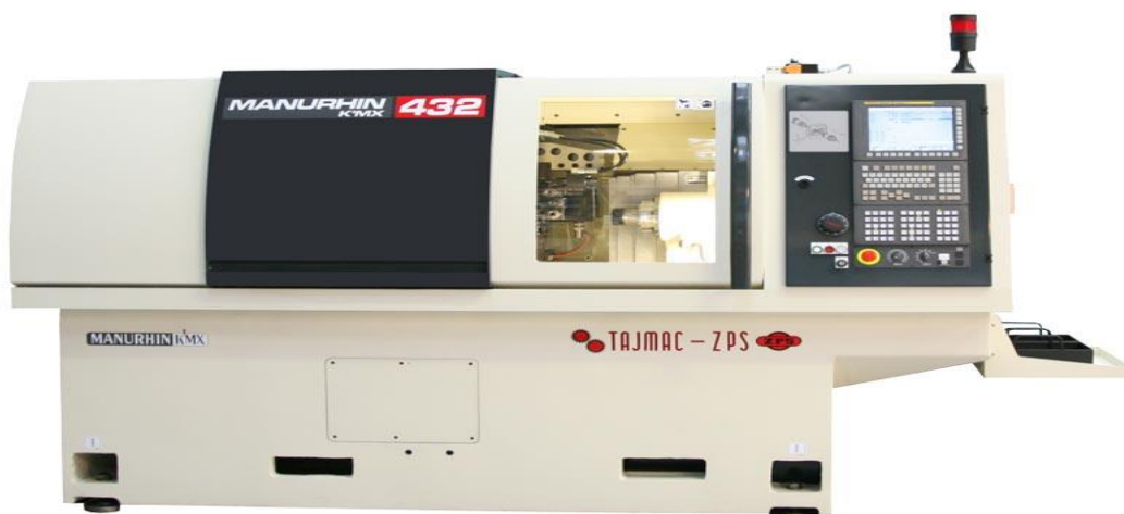
Obr. 13 Dlouhotočný CNC automat KMX 432 (vlastní zpracování dle interních materiálů)
