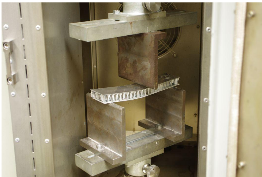
Obr. 57. Zkouška v teplotní komoře při 70 °C
