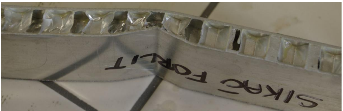
Obr. 83. Hliníkový panel s lepidlem 5 po zkoušce ohybem
