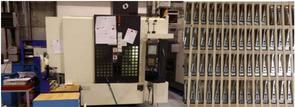
Obrázek 28 – Makino S56 s typickým představitelem (vlastní zpracování)
