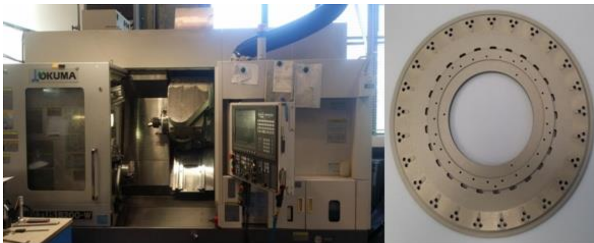
Obrázek 27 – Okuma Multus s typickým představitelem (vlastní zpracování)
