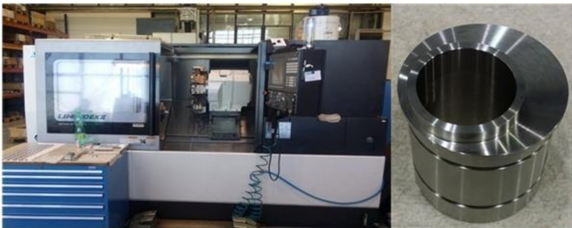
Obrázek 26 - Okuma LB 4000 s typickým představitelem (vlastní zpracování)
