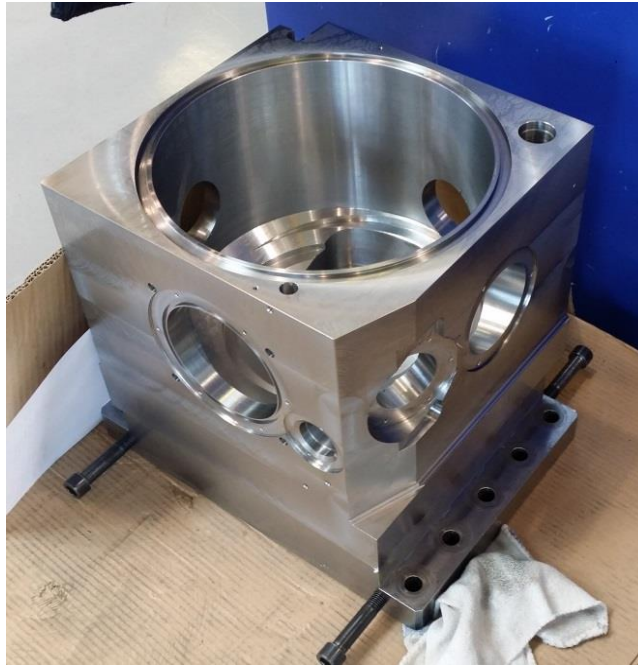
Obrázek 17 – Obrobek po 1. upnutí (vlastní zpracování)
