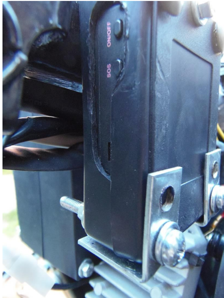
Obr. 30. Ukázka instalace Tk – 102 na motocykl Jawa 250 [Zdroj vlastní]
