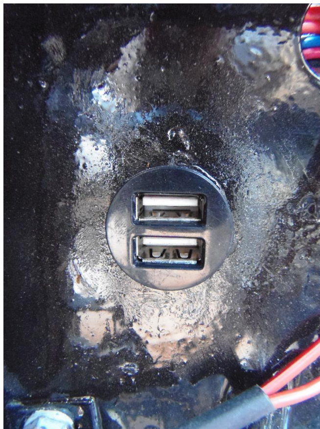
Obr. 29. Ukázka zabudování USB zásuvky s měničem napětí [Zdroj vlastní]
