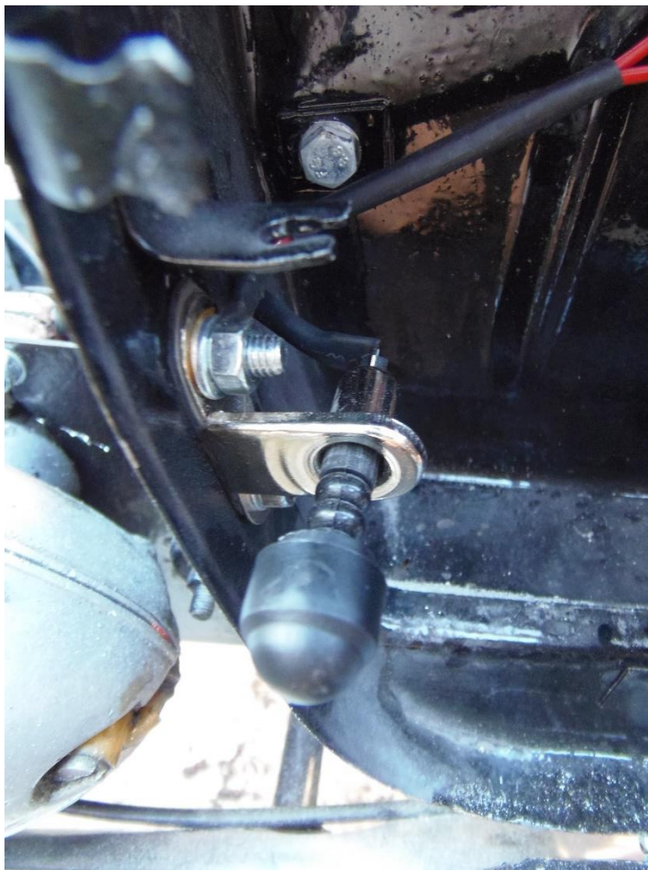
Obr. 28. Ukázka instalace kapotového spínače KG03[Zdroj vlastní]
