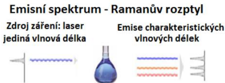
Obr. 11. Princip vzniku emisního spektra. [3]
