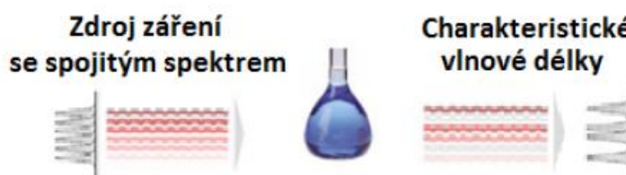
Obr. 14. Princip vzniku absorpčního spektra. [3]
