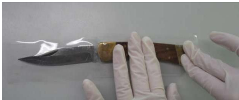
Obr. 24. Tape Lifting na noži. [32]
