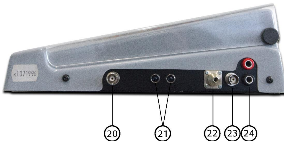
Obrázek 8: Pohled na pravou stranu vysílací části sestavy s popisem výstupů[autor]
