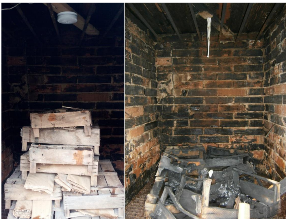
Obr. Autonomní hlásič před a po účinku přímého plamene
