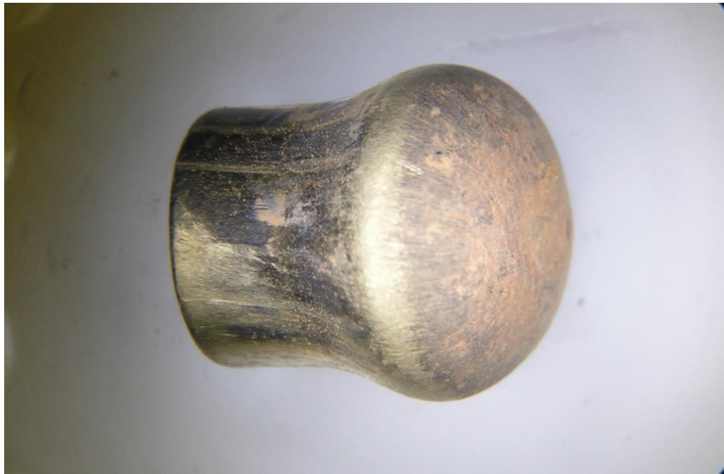
Obr. 63. Střela po zásahu cihly pálené duté [Vlastní zdroj]
