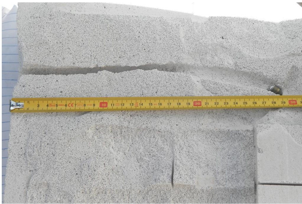
Obr. 41. Střelný kanál pórobeton Ytong [Vlastní zdroj]
