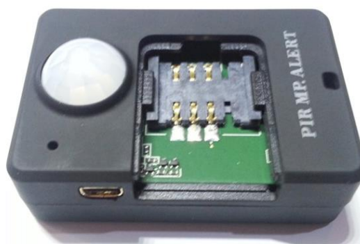
Obr. 11 : GSM odposluch s PIR detektorom [22]
