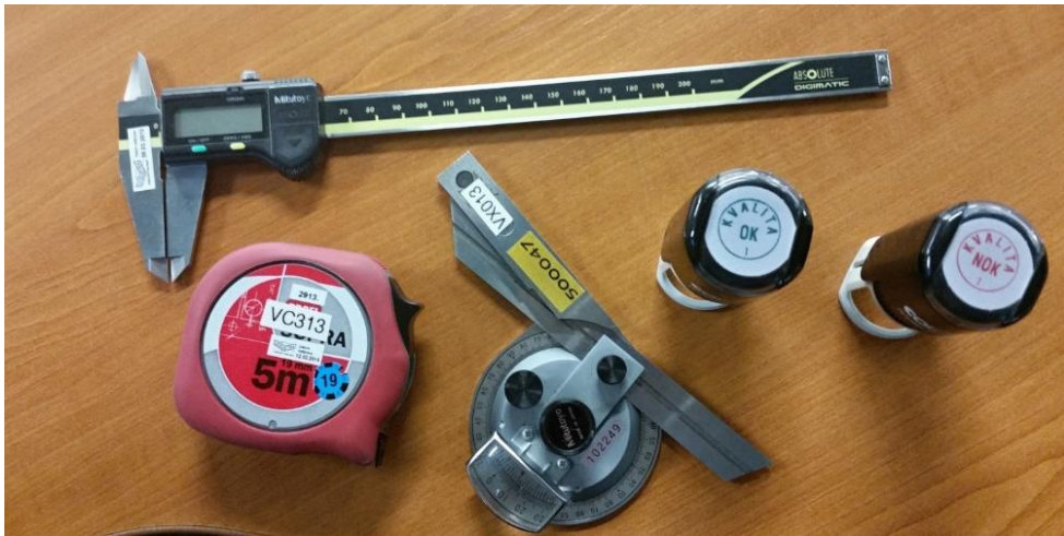
Obrázek 9 - Měřící zařízení vstupní kontroly (vlastní zpracování)
