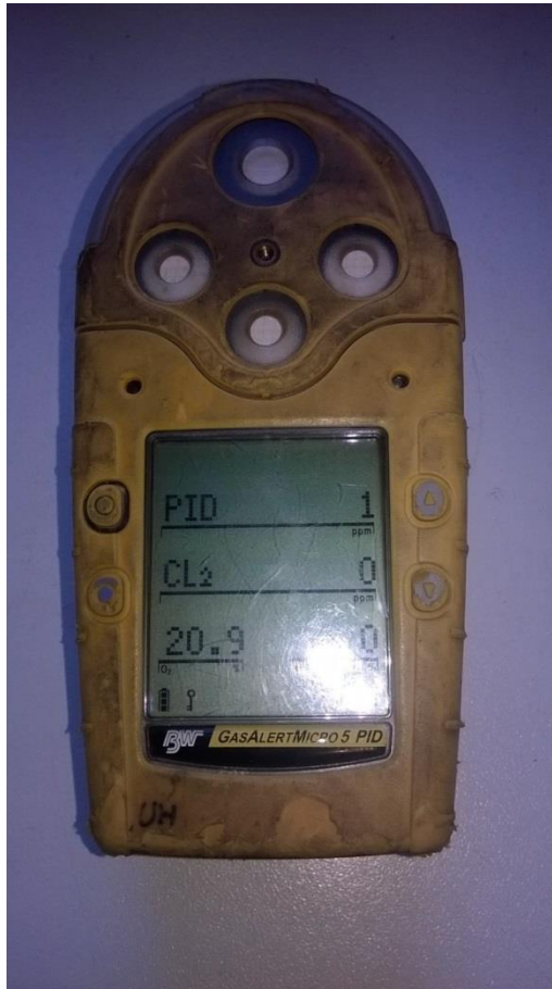
Detekční přístroj GASALERTMICRO 5 PID - pro měření koncentrace chlóru [Zdroj: vlastní]
