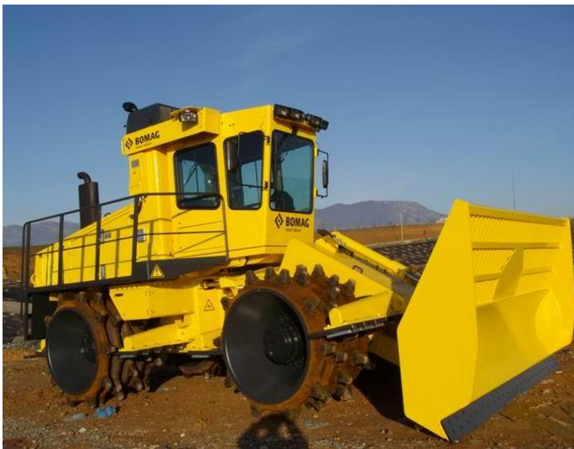
Obr. 5. Kompaktor BOMAG BC 572 RB využívaný na skládce Suchý důl [31]
