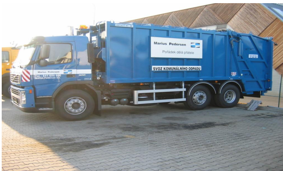
Obrázek 7: Vozidlo PRES třínápravové s lineárním lisováním [15]
