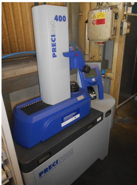
Obr. 12 Přístroj pro seřizování nástrojů (vlastní zpracování)
