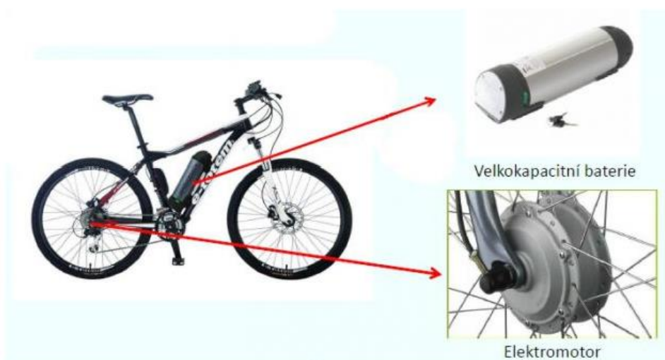
Obr. 9. Elektrokolo a jeho specifické součásti (Zdroj: JEDEME VŠICHNI, © 2016b)
