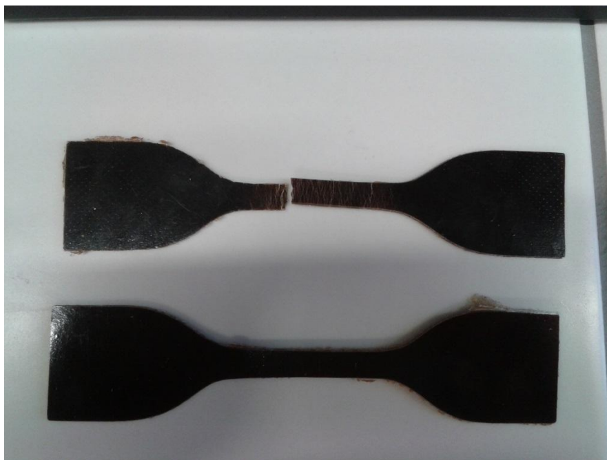
Obrázek 14 Vysekané lopatky směsi číslo 3 pro tahovou a po tahové zkoušce
