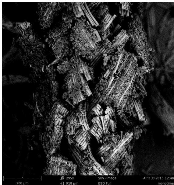
Obr. 51. Snímek z elektronové mikroskopie, Polysorb LL-223 po degradaci
