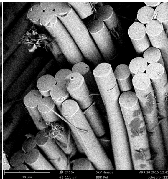
Obr. 52. Snímek z elektronové mikroskopie, Polysorb LL-223 po degradaci (detail vláken)
