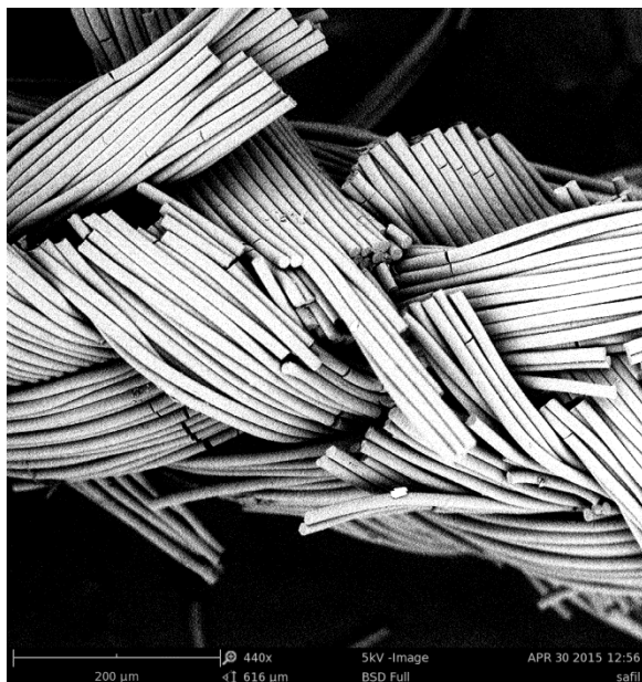
Obr. 56. Snímek z elektronové mikroskopie, Safil po degradaci
