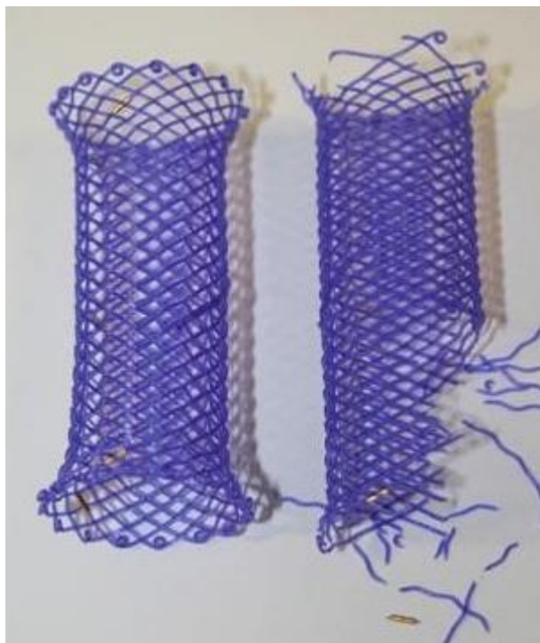
Obr. 24. Spontánní rozpad biologicky rozložitelného jícnového stentu (Ella-BD) po 18 měsících působením pokojové teploty [70]
