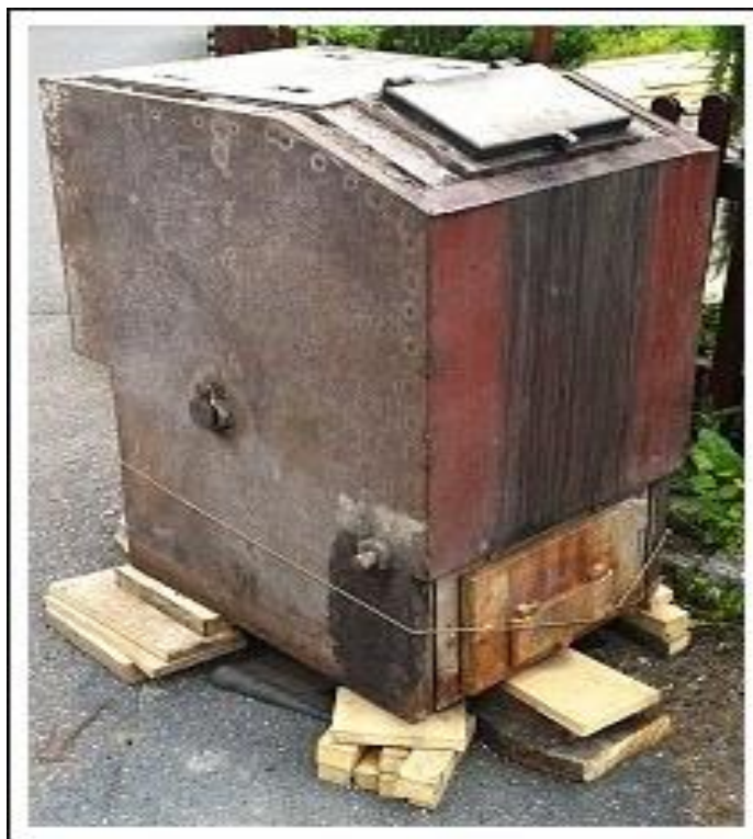
Obr. 3. – starý kotel na tuhá paliva [27]
