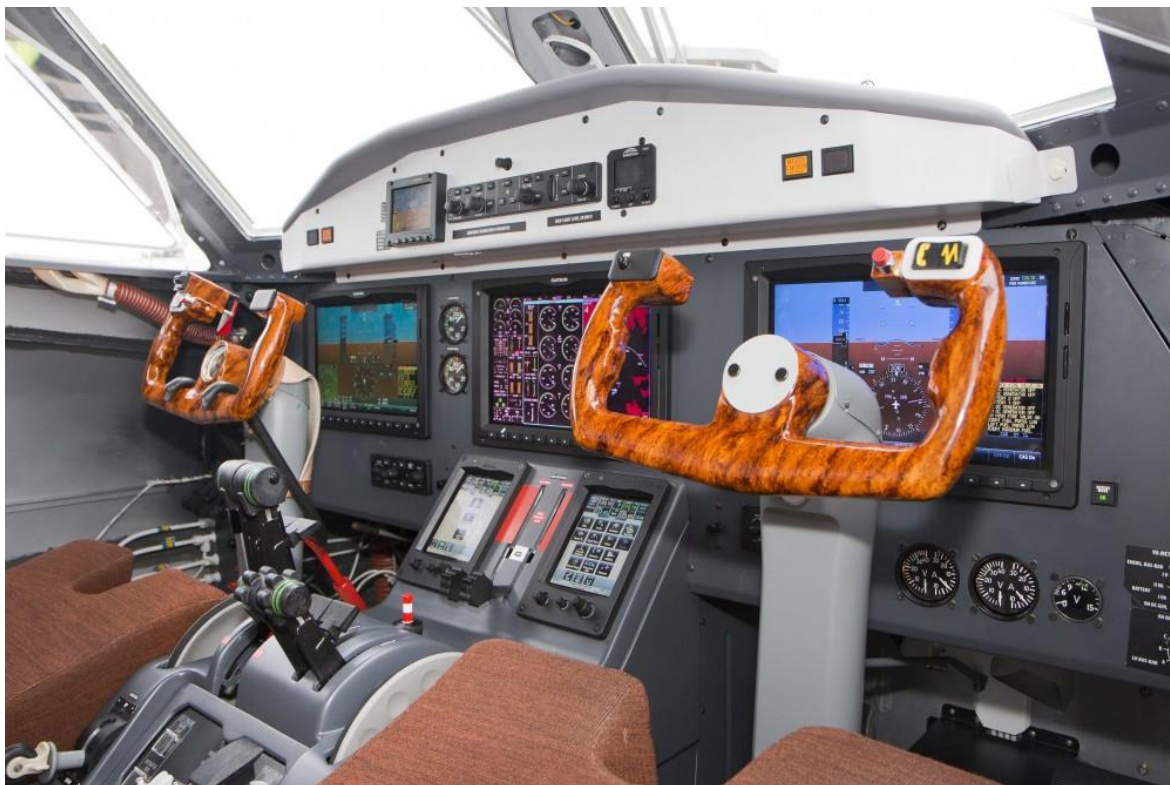
Příloha 5: Kabina nově vyráběného letounu L 410 NG [21]
