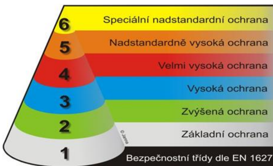
Obr. 2 Bezpečnostní třídy dle normy ČSN EN 1627 [5]
