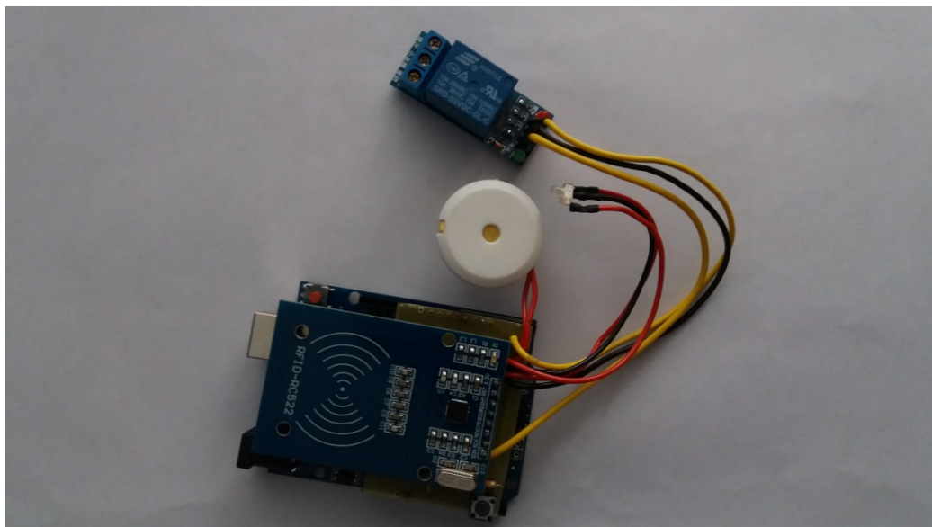
Obr. 14 – Výsledný prototyp systému kontroly vstupu
