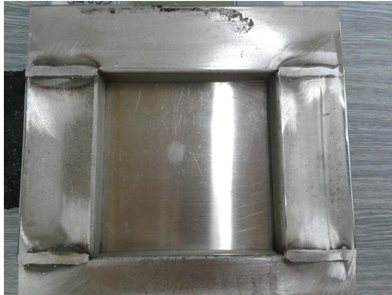
Obrázek 25: Forma pro přípravu vzorků, které byly rozštípany
