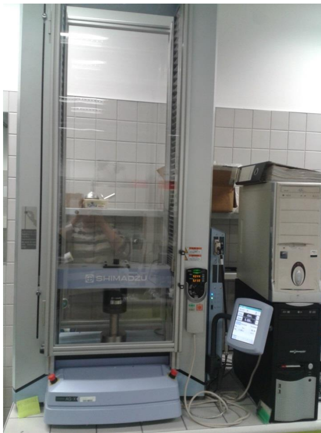
Obrázek 28: Trhací stroj Schimadzu pro tlakovou zkoušku
