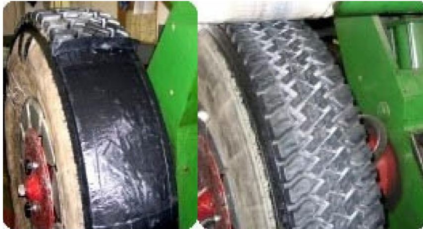
Obrázek 2: Ukázka protektorování za studena [11]
