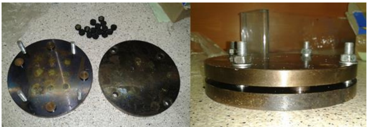
Obrázek 27: Ukázka rozložené a složené formy pro stanovení trvalé deformace
