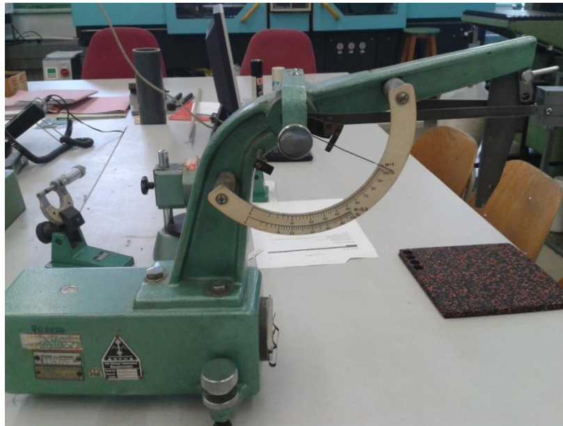
Obrázek 29: Příklad přístroje Schob k určení odrazové pružnosti
