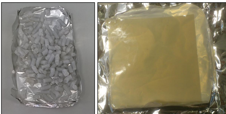
Obrázek 12: Ukázka vytlačené struny EVA + 1 % ZnO (nalevo) a vylisované kompozitní destičky Versify 3401 + 1 % Ag-ZnO-1 (napravo)
