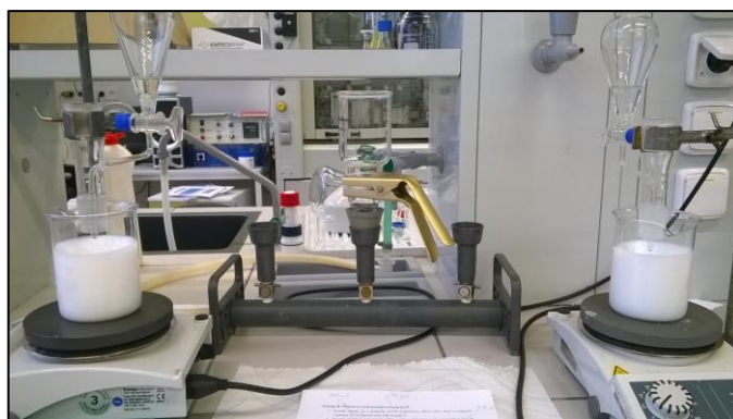
Obrázek 6: Syntéza ZnO (nalevo) a Ag-ZnO-1 (napravo) s následnou filtrací
