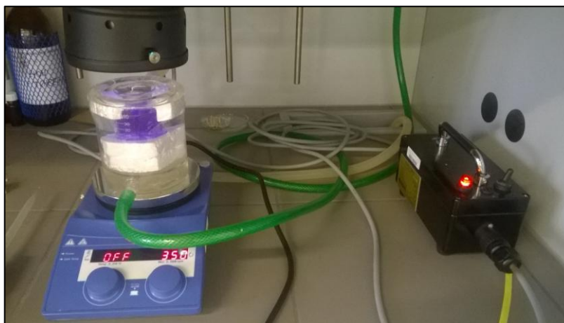
Obrázek 11: Sestavená aparatura potřebná pro průběh fotokatalytické aktivity plniv
