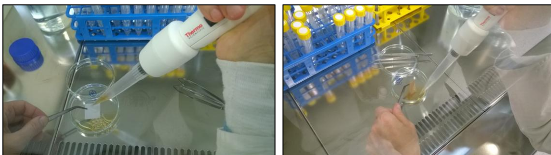
Obrázek 14: Ukázka oplachovací metody dle ISO 22196
