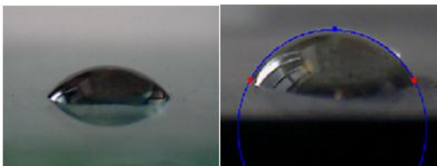
Obrázek 43 – příklad chování kapky vody na povrchu filmu modifikace PANI-silika a její vyhodnocení
