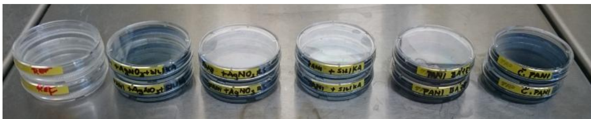
Obrázek 39 – polystyrenové misky připravené pro měření buněčné adheze
