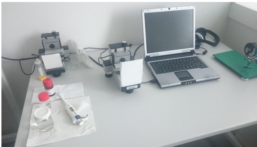
Obrázek 38 – SEE Systém pro měření kontaktního úhlu sedící kapky, který byl využit pro praktickou část
