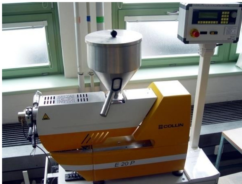
Obr. 8 Jednošnekový vytlačovací stroj COLLIN E 20 P. L/D = 25
