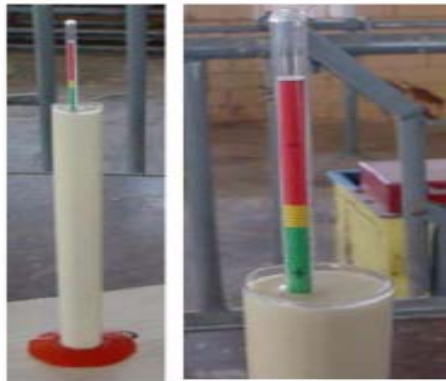
Obr. 9. Kolostrometr (vlevo – použití kolostrometru, vpravo – stupnice kolostrometru) [40]
