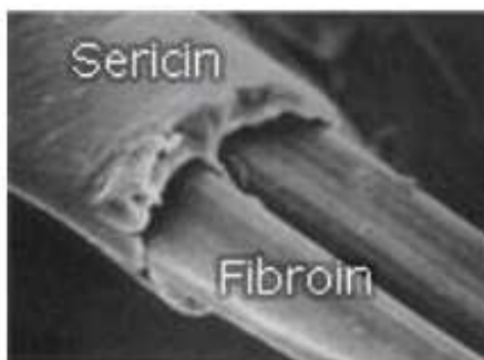
Obr. 11. Struktura sericinu a fibroinu v hedvábném vlákně [75]
