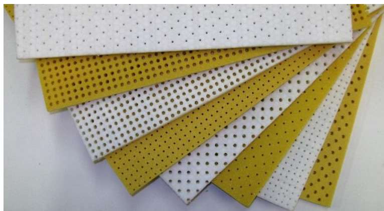
Obr. 57 Pěnové jádra s připravenými otvory pro vyztužující žebra
