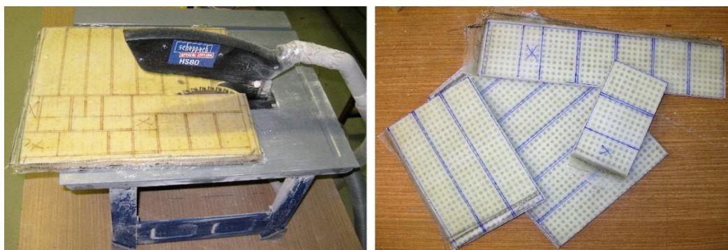
Obr. 76 Řezání sendvičových konstrukcí na testovací vzorky
