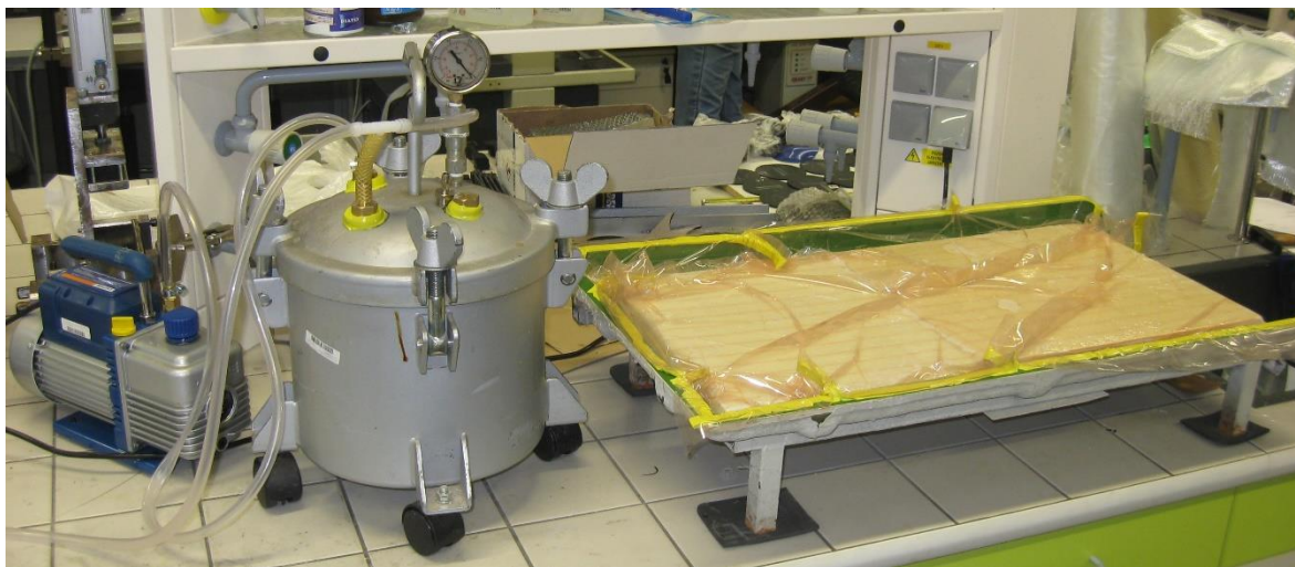
Obr. 61 Zavakuovaný sendvičový panel pod pružnou fólií po ruční laminaci
