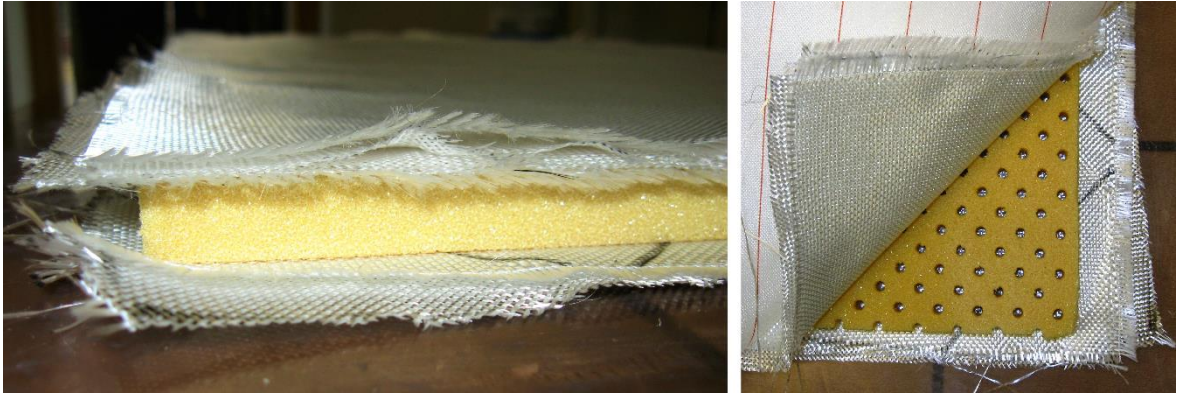
Obr. 71 Naskládané vrstvy sendvičové konstrukce
