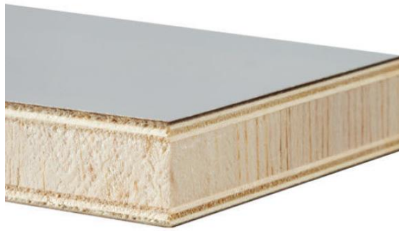
Obr. 13 Příklad sendvičové konstrukce s balsovým jádrem [22]
