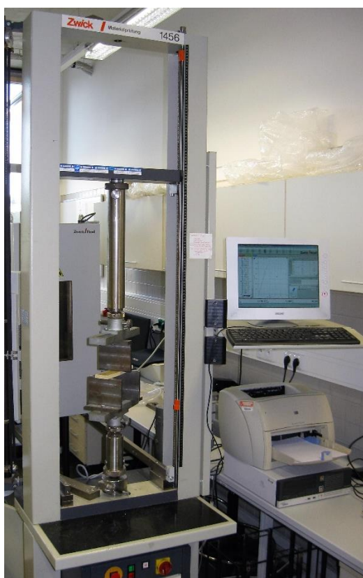
Obr. 80 Univerzální zkušební stroj ZWICK 1456
