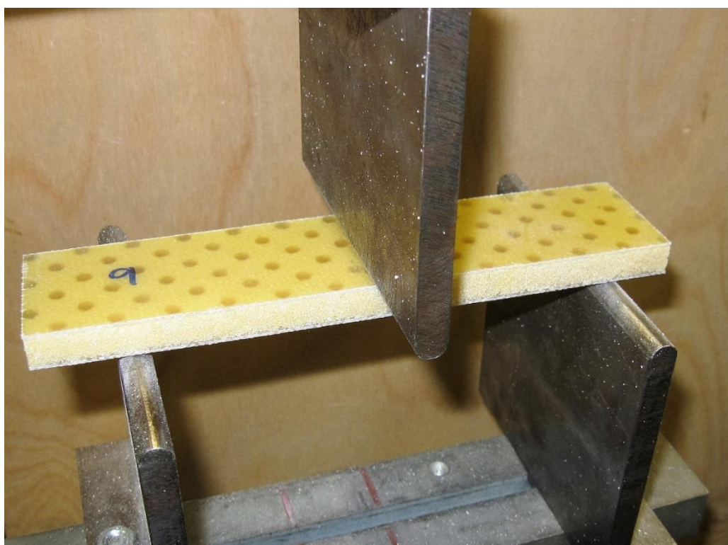
Obr. 88 Tříbodová ohybová zkouška sendvičové konstrukce s pěnovým jádrem Airex C70.55/10 mm
