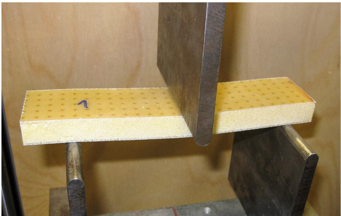
Obr. 94 Třibodová ohybová zkouška sendvičové konstrukce s pěnovým jádrem Airex C70.55/15 mm
