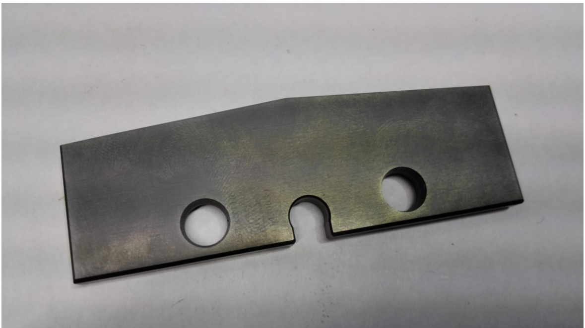
Obr. 44. Povlak AlCrN nanesený na dělicí destičce 76,2 mm x 5,0 mm.
