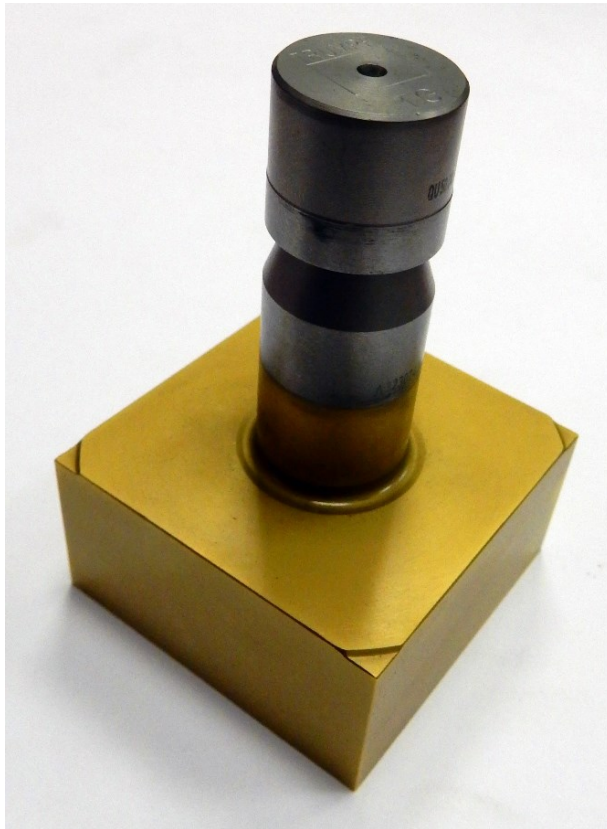
Obr. 49. Čtvercový střížník 50,0mm x 50,0mm s povlakem TiN.
