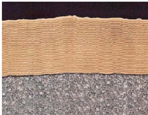
Obr. 26. Multivrstevný systém TiN – TiCN [20].
