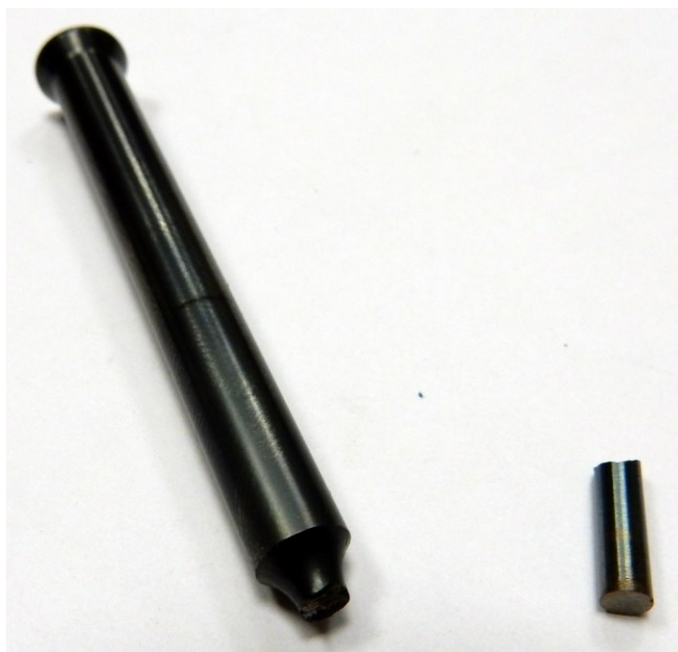
Obr. 47. Zlomený kruhový střížník Ø 3 mm s povlakem TiCN.
