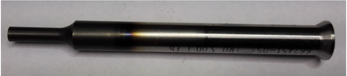
Obr. 43. Kruhový střížník \varnothing 3 mm s povlakem TiAlN + WC/C firmy Oerlikon.
