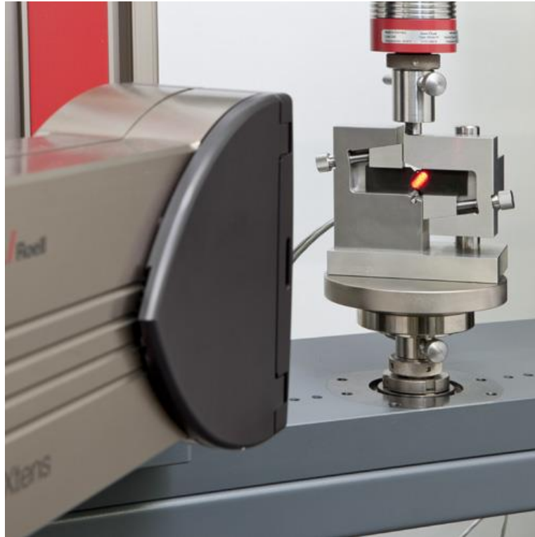
Obrázek č. 37 Měření deformace laserovým extenzometrem
