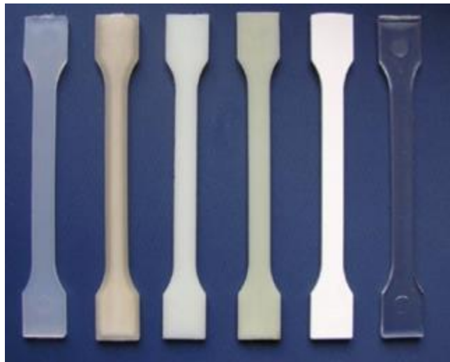
Obrázek č. 4. Zkušební tělesa pro tahovou zkoušku u kompozitů
