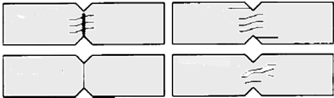
Obrázek č. 16 Typické přijatelné poruchy zkušebního vzorku ASTM D 5379
