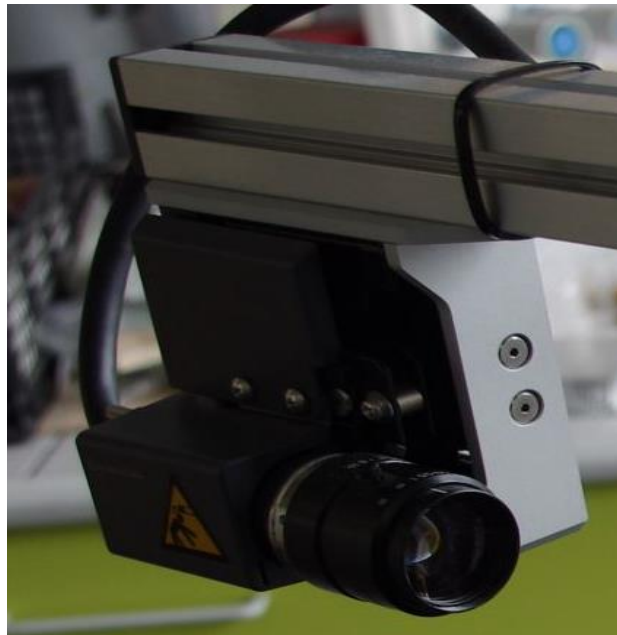
Obrázek č. 36 Videoextensometr zkušebního stroje Shimadzu AG-CC 50kN
