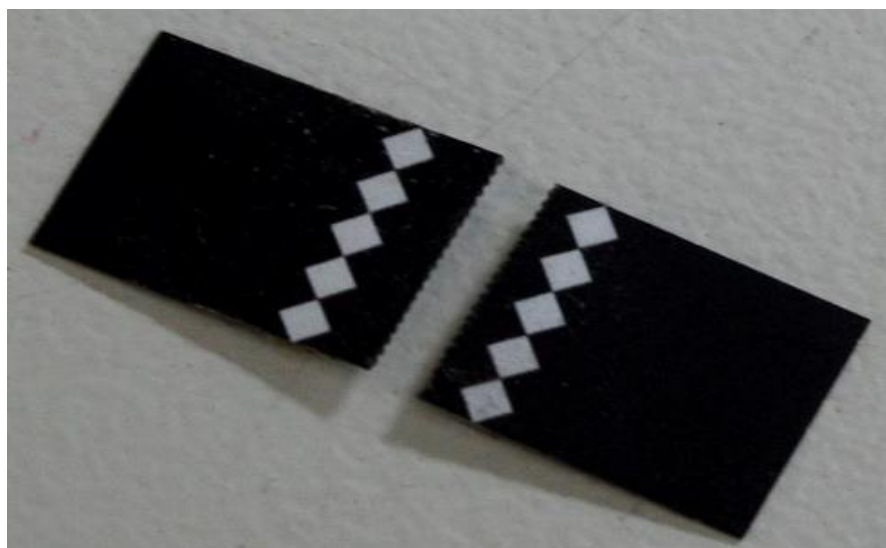
Obrázek č. 34 Značky pro vyhodnocování zkoušky pomocí videoextenzometru
