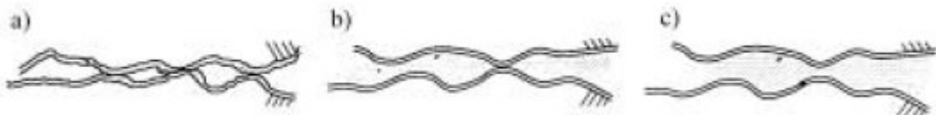
Obr. 6. Typy mazání a) mezní b) částečné fluidní c) plné fluidní
