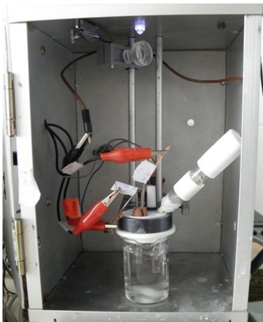
Obr. 11: Potenciostat L-chem s tříelektrodovým zapojením pro aktivaci mikrosenzoru.
