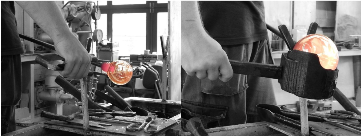
Obr. 19 základní baňka a tvarování „svalákem“, foto: Mikuláš Starý
