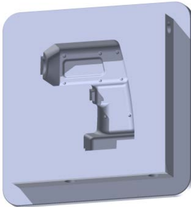
Obr. 1. 3D model vložky dutiny vstříkovací formy
