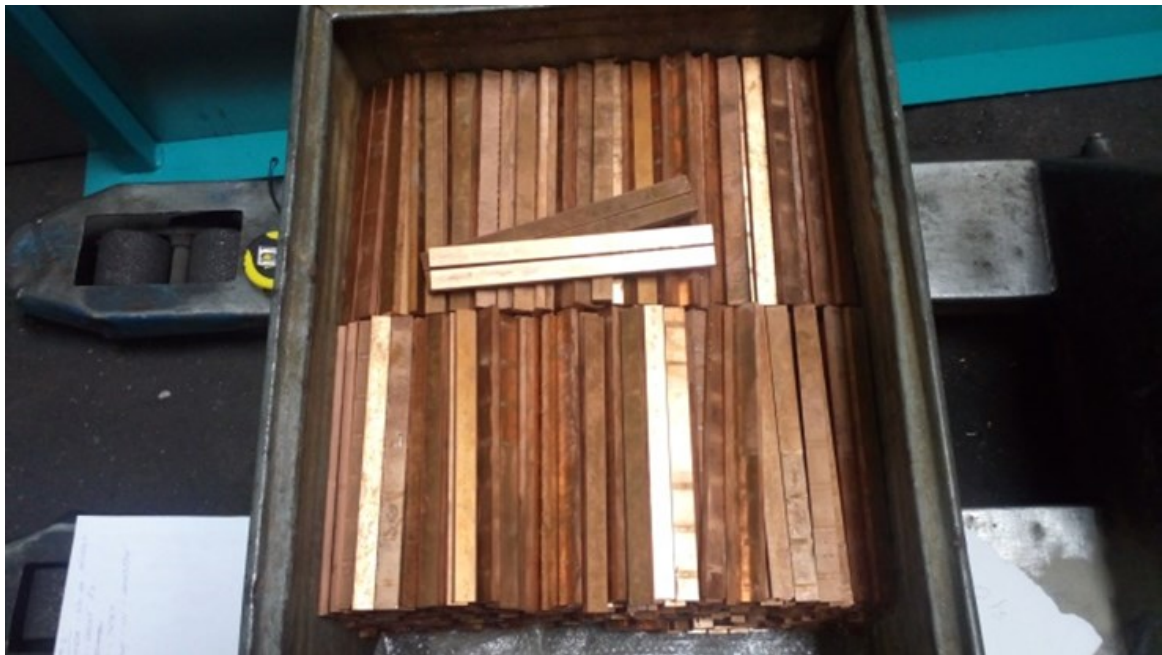
Obr. 9 Pásky nařezané pásovou pilou a připravené pro obrábění
