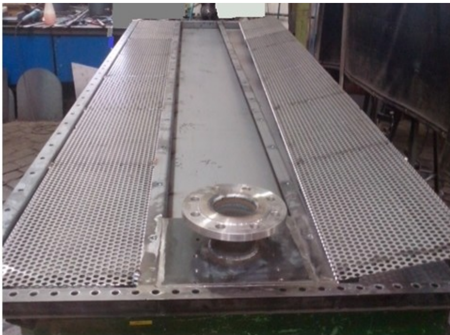
Obrázek 20 Provzdušňovací panel před dokončením ve fázi svařování, vlastní foto
