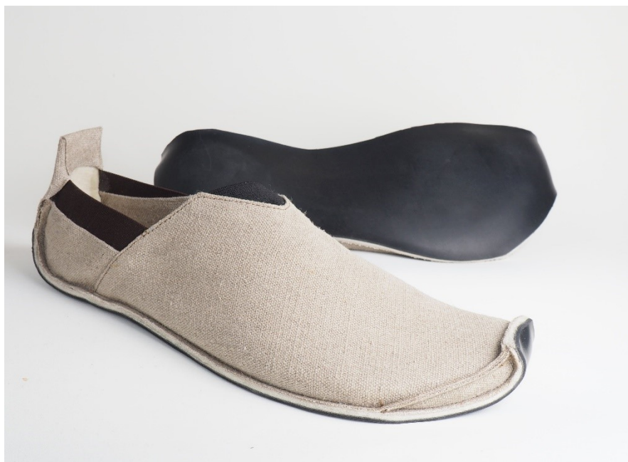
Obrázek č. 34 - Textilní obuv s tenkou nedežénovanou pryžovou podešví (před testem)
