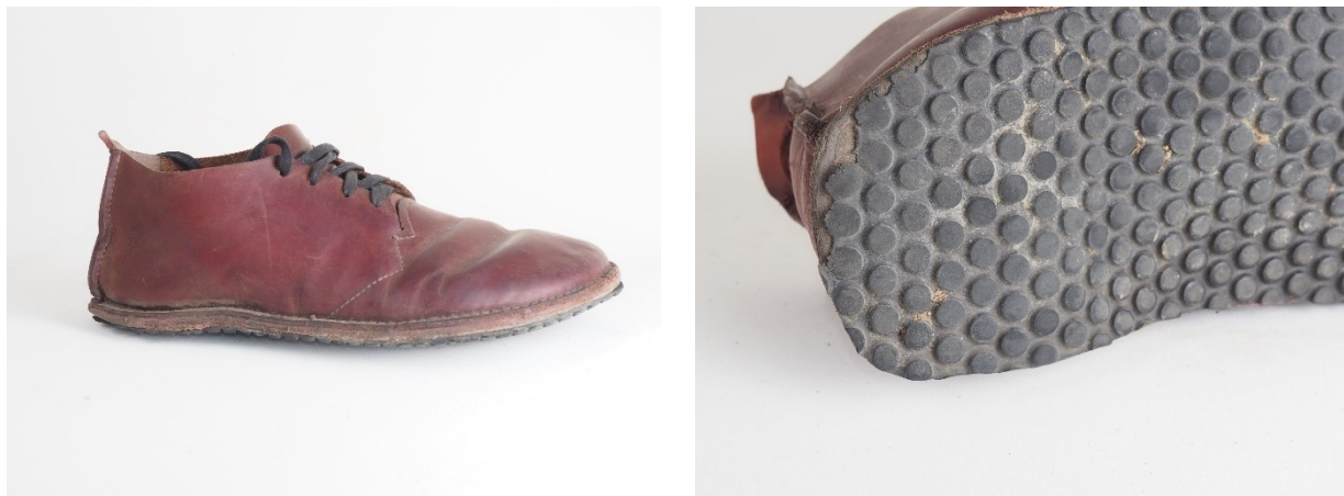
Obrázek č. 33– Druhý testovací pár obuvi (po opotřebení)
