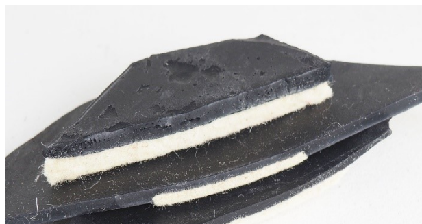
Obrázek č. 26 – Vzorek pryže lisované na filc
