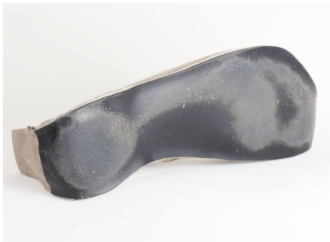
Obrázek č. 35 - Textilní obuv s tenkou nedežénovanou pryžovou podešví (po opotřebení)
