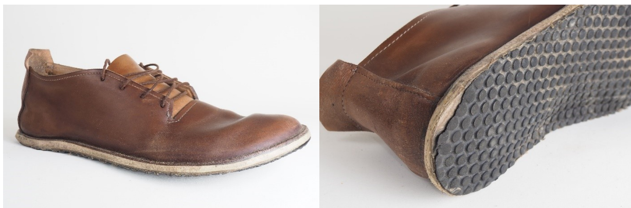
Obrázek č. 31– Bota s pryžovou dezénovou podešví (po opotřebení)
