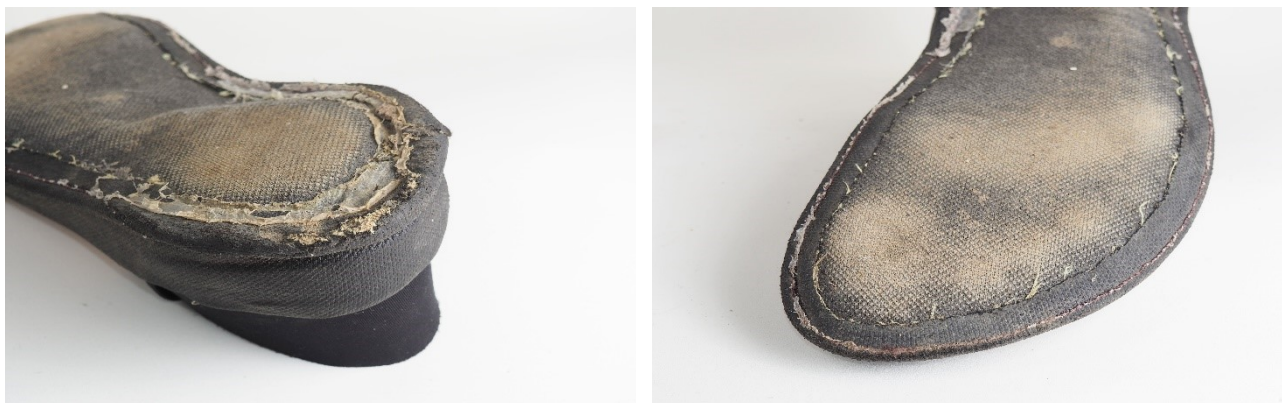
Obrázek č. 24 - Druhá testovací bota (filc + nánosovaná textilie) – po opotřebení
