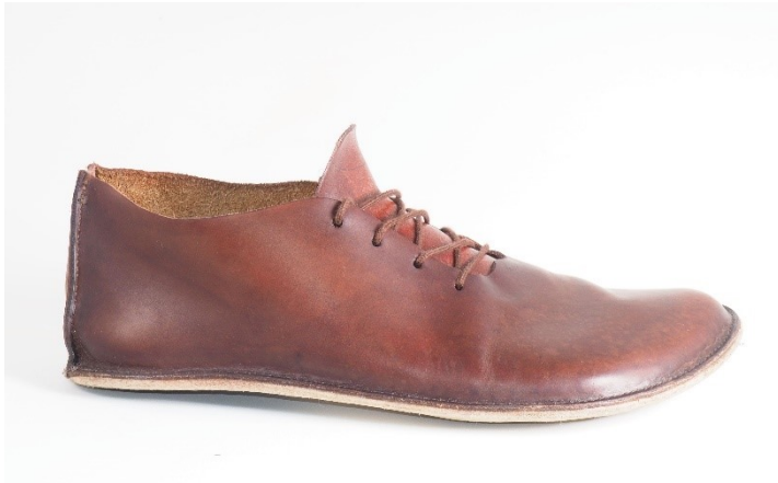
Obrázek č. 21 – První experimentální bota (filc + PU zátěr) – před testem
