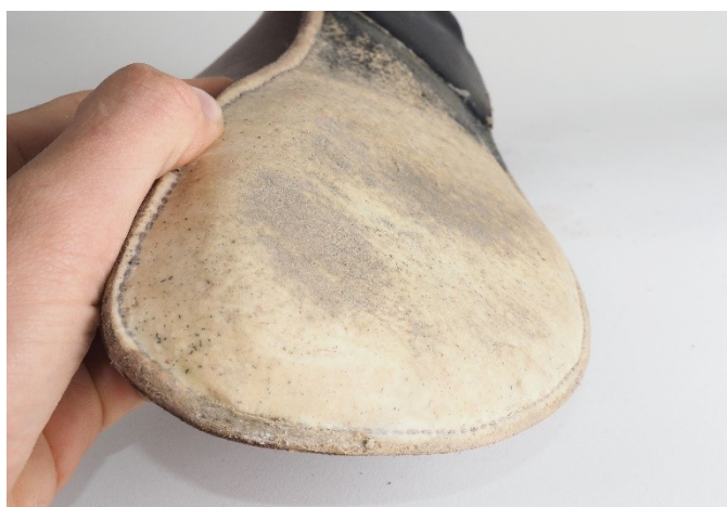
Obrázek č. 22 - Druhá testovací bota (filc + nánosovaná textilie) – po opotřebení
