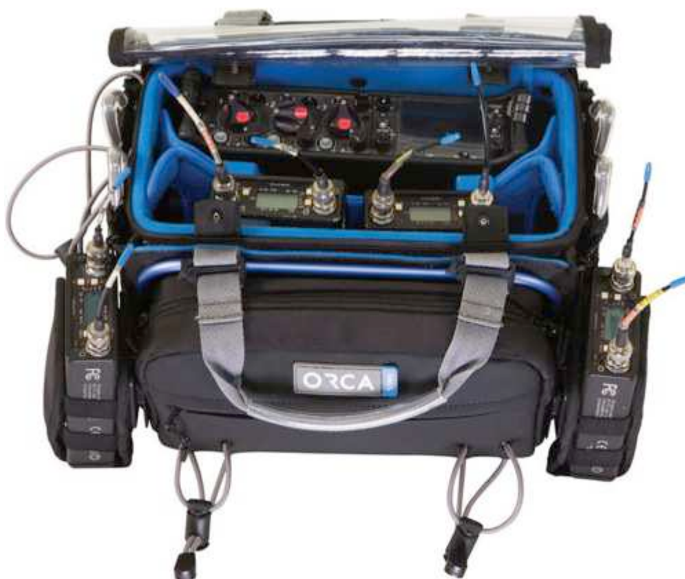
Obrázek 39 – Příklad dokumentárního zvukového setu se záznamem SoundDevices 633 a kombinace 4 bateriových jednokanálových přijímačů Lectrosonics UCR 411
