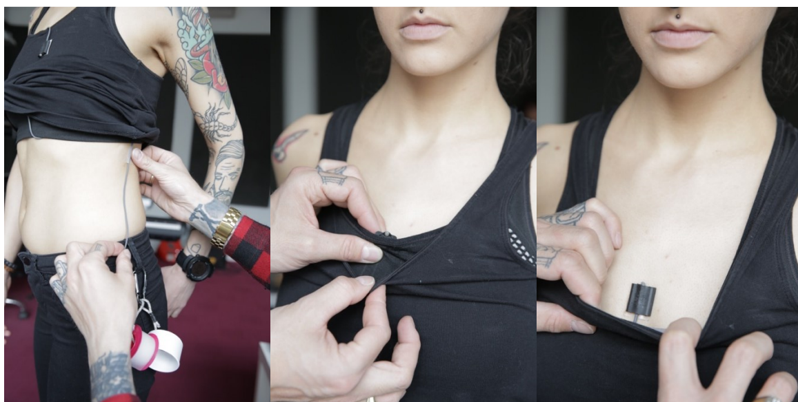
Obrázek 32, 33 a 34 - Ukázka aplikace mikrofonní kapsle na tělo i kostým za pomoci „gumídku“ a oboustranné pásky Topstick. Vedení kabelu pod lemem pevné sportovní podprsenky a pojistné uchycení lékařskou páskou Urgofilm.
