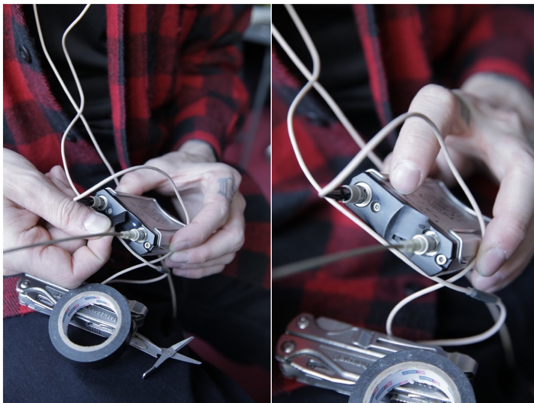
Obrázek 75 a 76 - Ukázka přelepení diody za pomoci „tejpy“ v případě, že nám dioda prosvětluje kostým.
