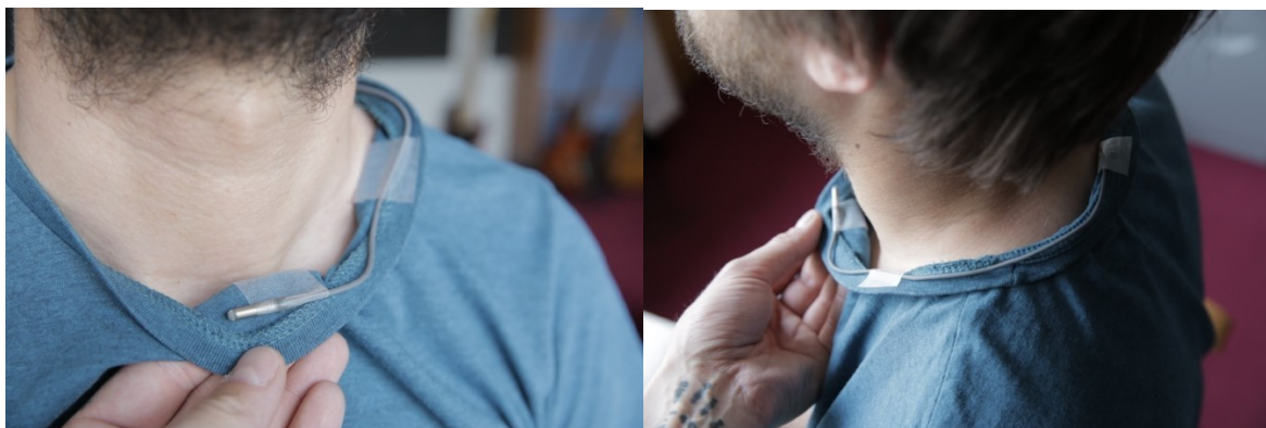
Obrázek 28 a 29 - ukázka aplikace mikrofonní kapsle za použití lékařské pásky Urgofilm.
