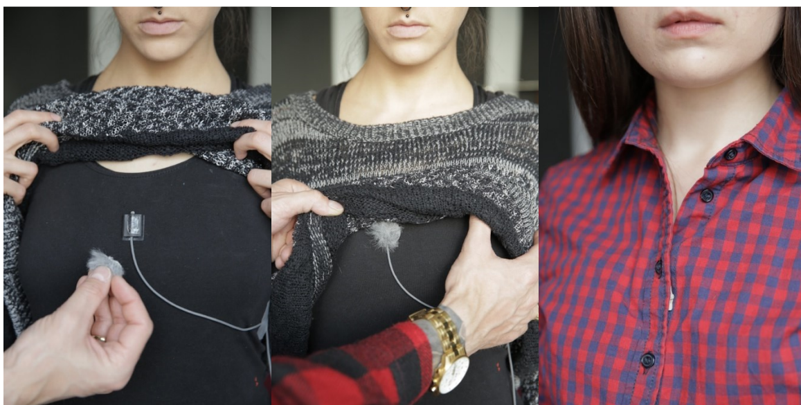
Obrázek 54 a 55 - zleva: Ukázka překrytí uchycené mikrofonní kapsle za účelem eliminace pohybu pleteného materiálu.
