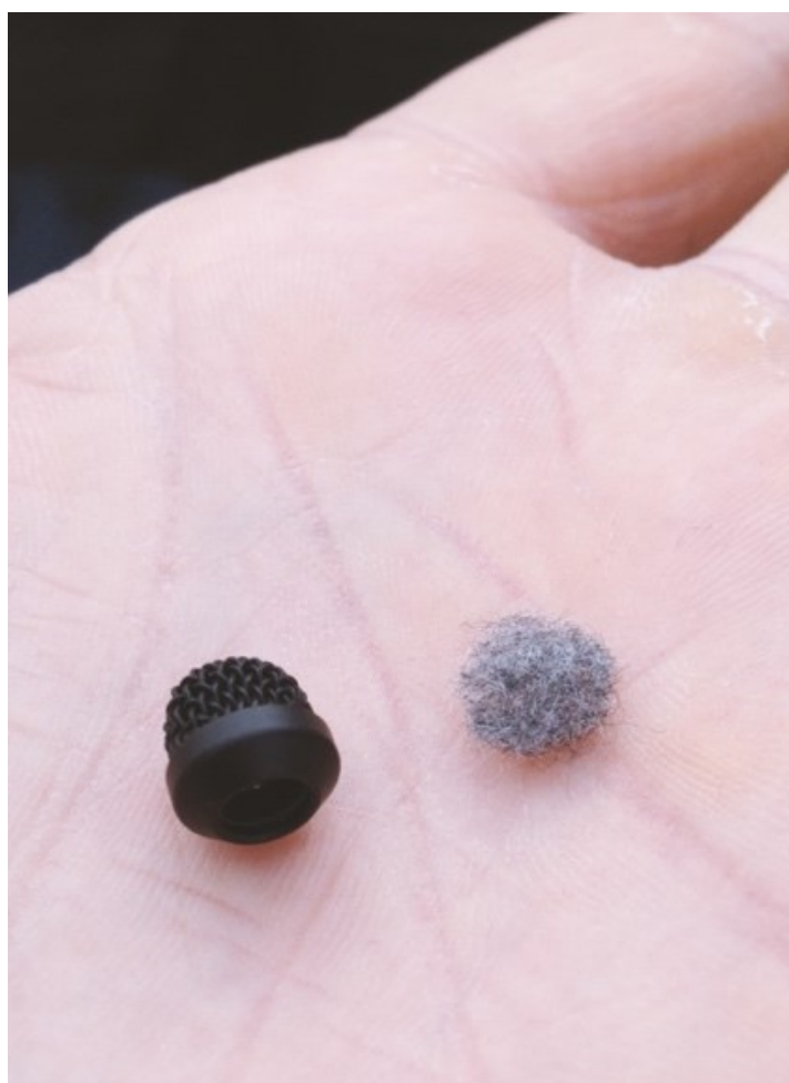
Obrázek 62 - Ukázka drátěné krytky pro mikrofonní kapsli Sanken a drobné vystřižené kolečko následně aplikované dovnitř drátěného „kloboučku“.
