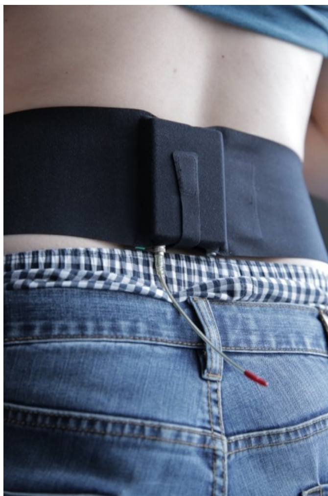
Obrázek 77 - Ukázka otočeného mikrofonního vysílače. Eliminujeme tak obrys antény na kostýmu.
