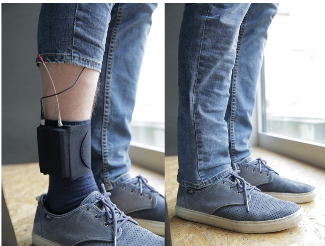
Obrázek 78 a 79 - Ukázka upevnění mikrofonního vysílače na kotník v praxi za pomoci bodybeltu od firmy Ursa Straps.
