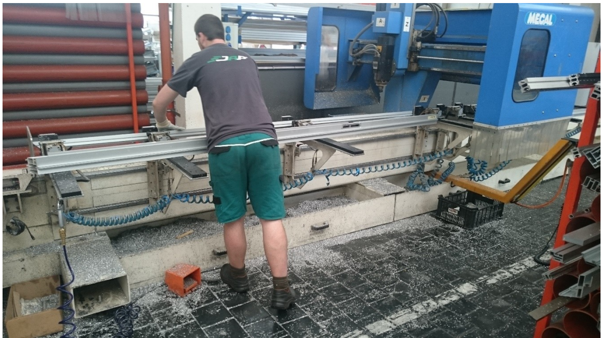
Obrázek 32 Uchycení profilu – frézka Mecal (vlastní zpracování)
