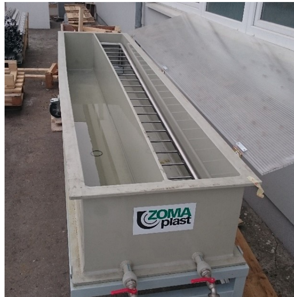
Obrázek 21 Odmašťovací lázeň (vlastní zpracování)
