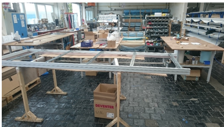
Obrázek 27 Montáž a balení zárubní (vlastní zpracování)
