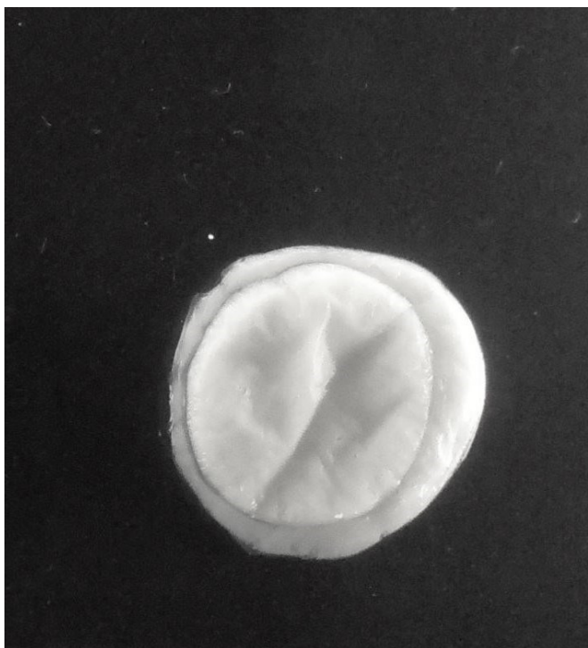
Obr. 6 Modelový vzorek sýru o obsahu tuku v sušině 30 % po roztečení
