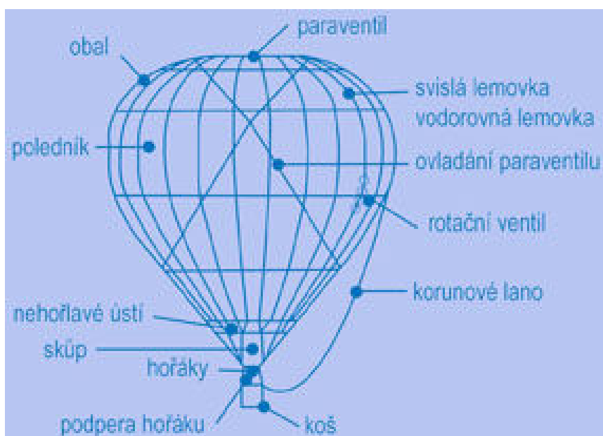
Obr. 2. Konstrukce horkovzdušného balónu [14]
