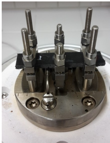
Obr. 41.: Upnutí vzorku pro dual cantilaver bending
